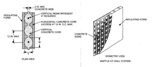
FIGURE R611.4 WAFFLE-GRID ICF WALL SYSTEM
