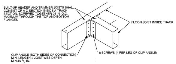
**BUILT-UP HEADER OR TRIMMER JOIST**
