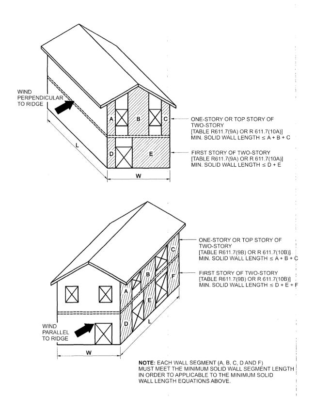
FIGURE R611.7.4 MINIMUM SOLID WALL LENGTH
